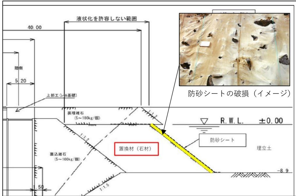
埋立が安定するまでに波によるばたつき等による埋込石との摩擦によりシートが破損し、構造物における吸出しの要因となる恐れがある。
